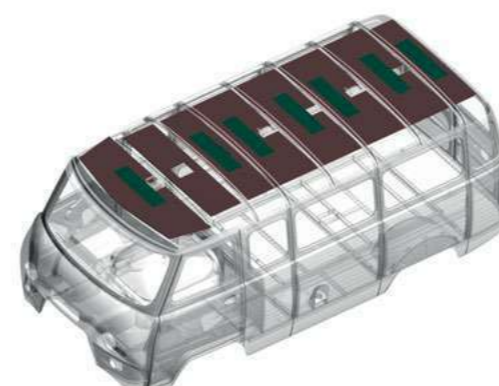
Иглопробивной материал обивки крыши
